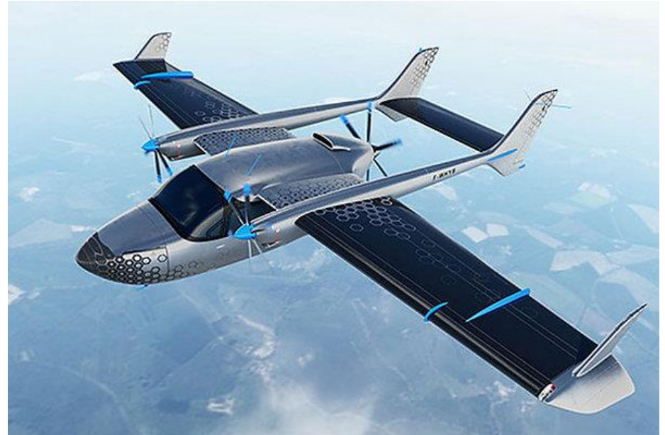
гибридный самолет Cassio 1 компании VoltAero с распределенной двигательной установкой
