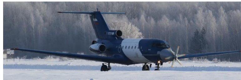
Як-40 с перспективным сверхпроводящим электрическим авиадвигателем в составе гибридной установки
