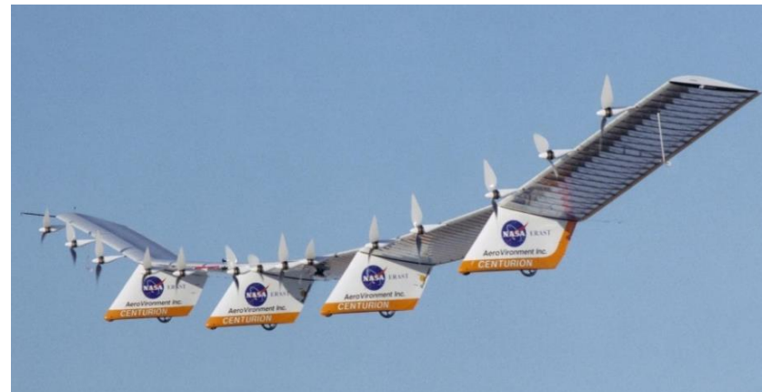
Стратосферник NASA "Centurion" - высота полета 30 км
