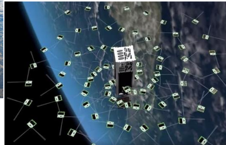
Аппараты Sprite ChipSats весят по 4 грамма – это класс фемтоспутников
