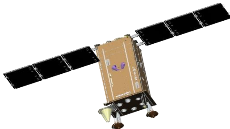
МКА «АИСТ-2ОИК» - обзорного и инфракрасного наблюдения
